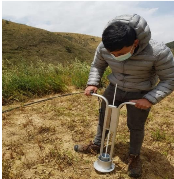
Figura 5. Infiltrómetro de doble anillo.
