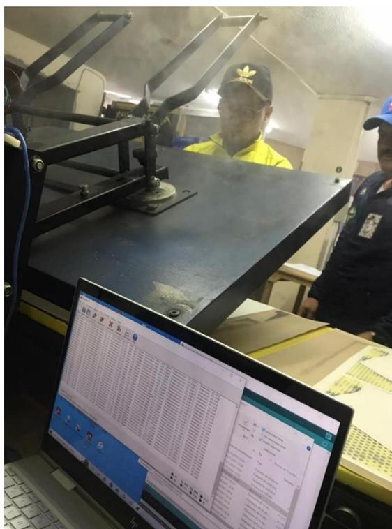
*Figura 10.* Máquina sublimadora en funcionamiento
