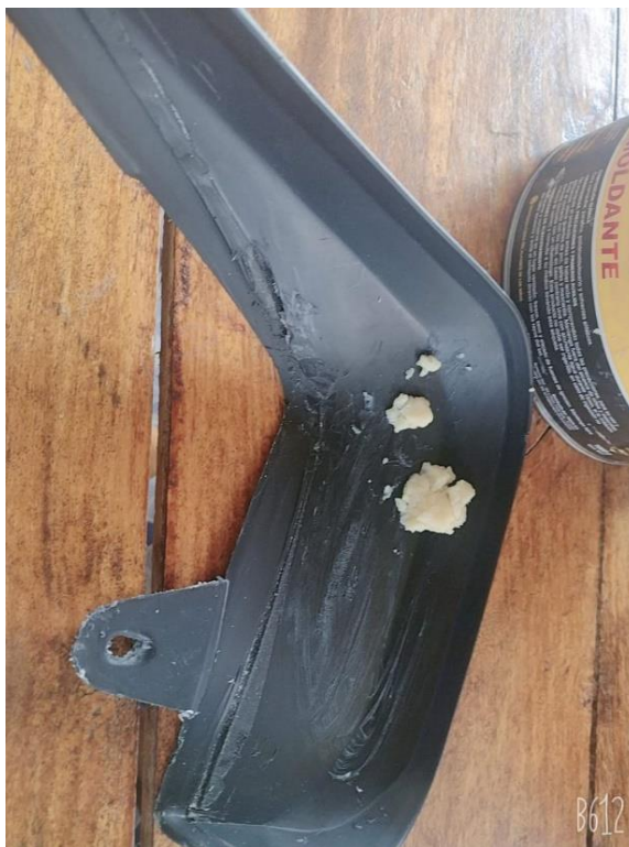
Figura 2.20 Aplicación de la cera desmoldante.
