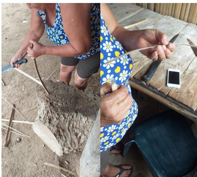
Figura 2.6 Extracción de la fibra de bambú
