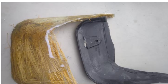
Figura 2.24 Desmolde del prototipo
