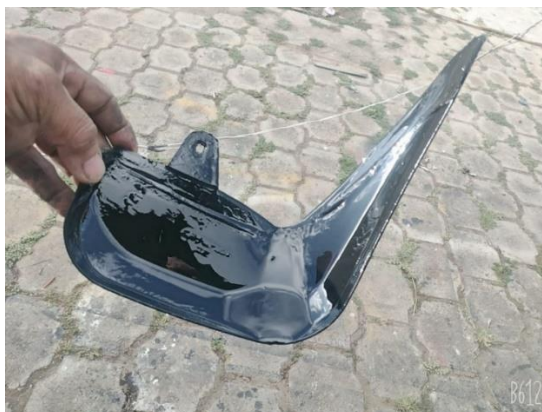
Figura 2.21 Aplicación de la resina epóxica.
