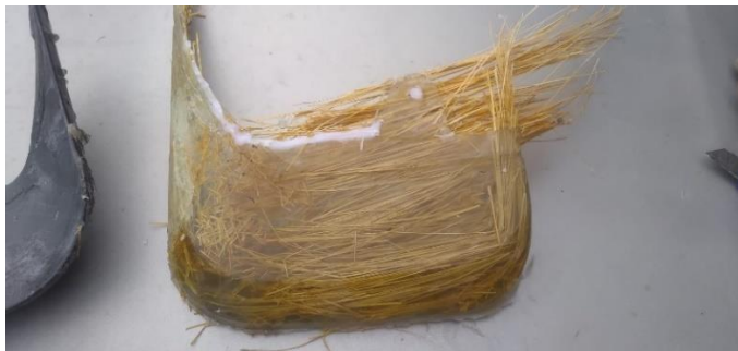
Figura 2.23 Secado del prototipo
