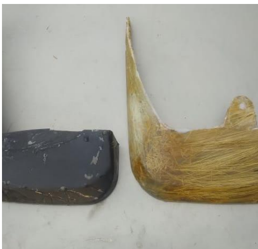
Figura 2.26 Pintado del prototipo guardabarros
