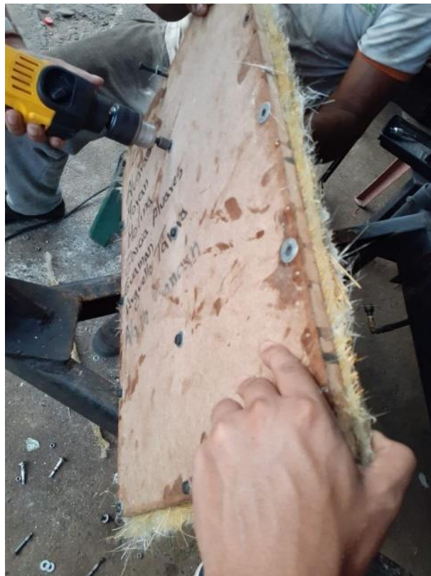
Figura 2.17 Desmolde del material compuesto
