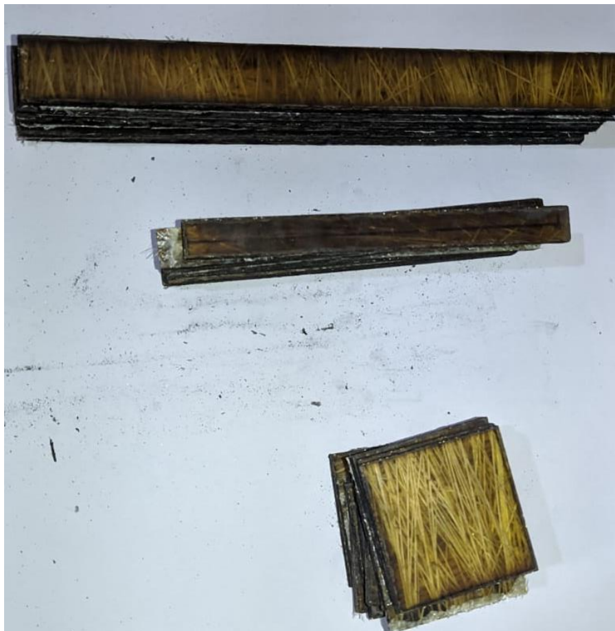
Figura 2.18 Probetas de tracción, flexión e impacto
