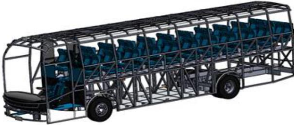
Figura 1.18 Carrocería Autoportante (Villafuerte Buñay, 2017, pág. 144)
