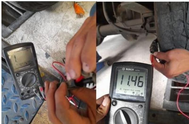
**Figura 3.2** Resistencia y señal rueda posterior derecha
