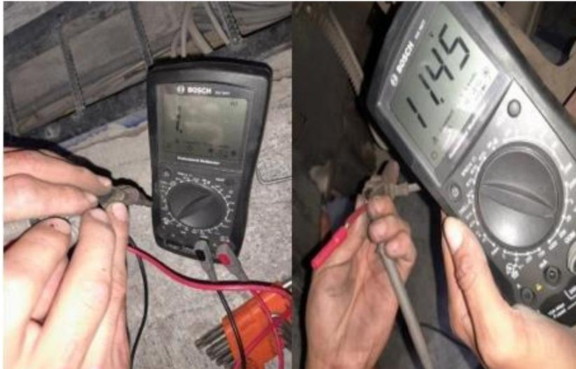
**Figura 3.3** Resistencia y señal rueda delantera derecha
