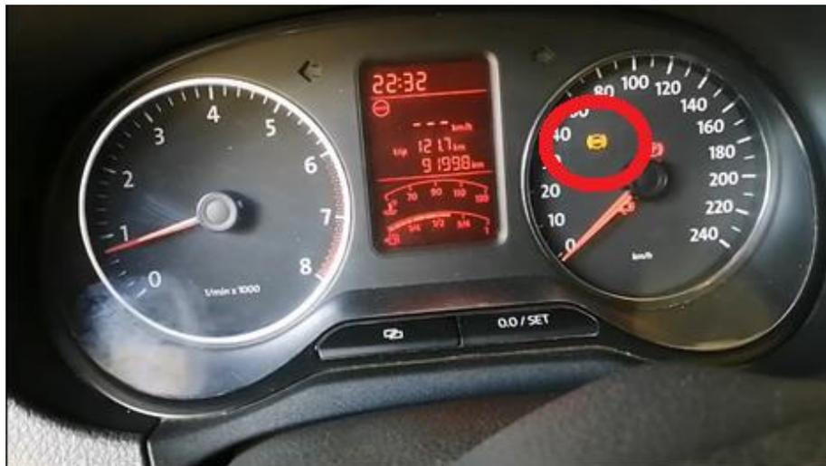
**Figura 3.27 Luz testigo de frenos ABS**
