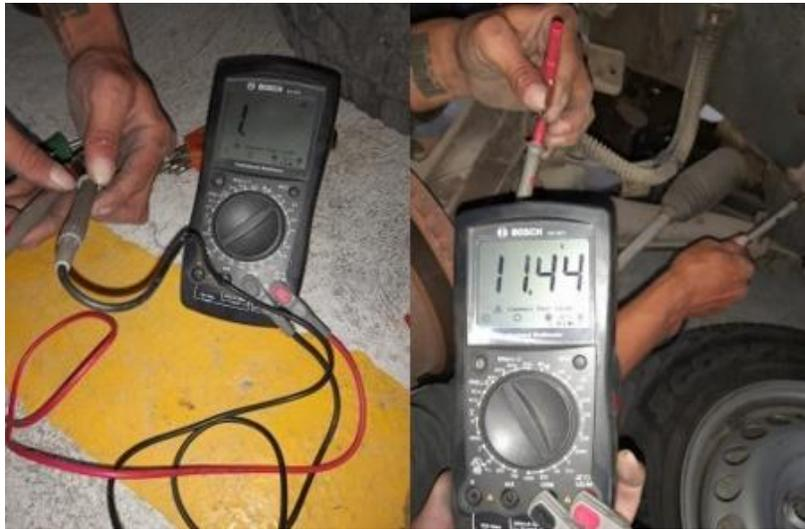
**Figura 3.4** Resistencia y señal rueda delantera izquierda
