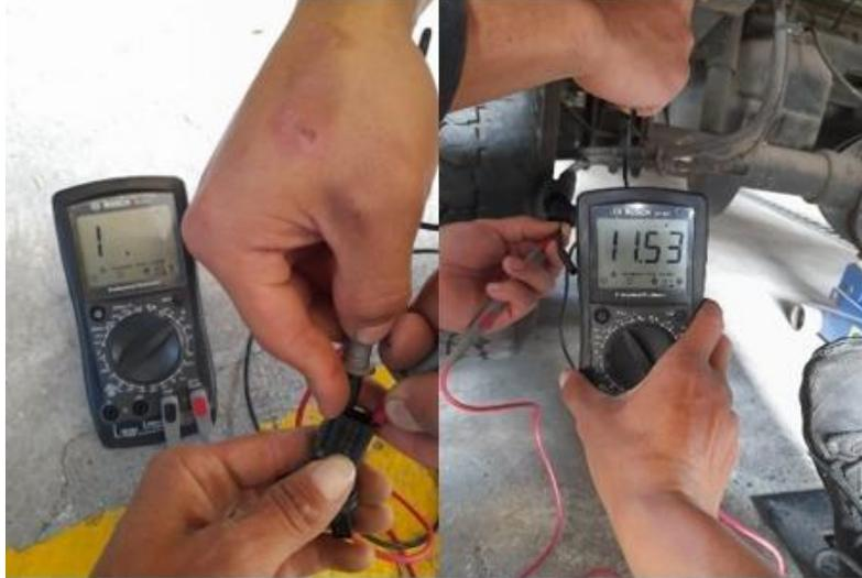
**Figura 3.1** Resistencia y señal rueda posterior izquierda
