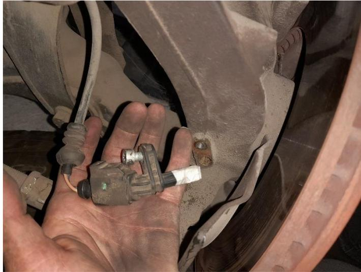
**Figura 3.29 Sensor recubierto por cinta de aislar**
