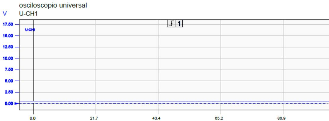
**Figura 3.26 Grafica del sensor de velocidad defectuosos.**
