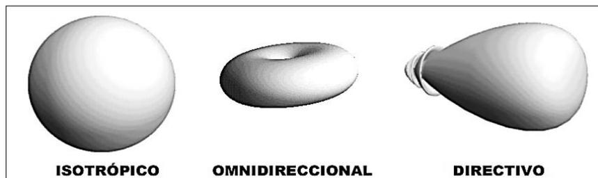
Figura 3. Diagramas de radiación en una antena.
