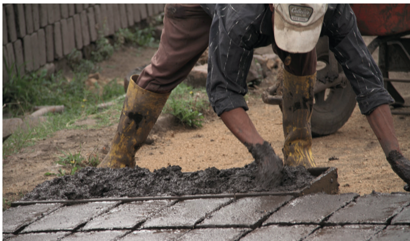
Figura 52. Proceso de elaboración del adobe.
