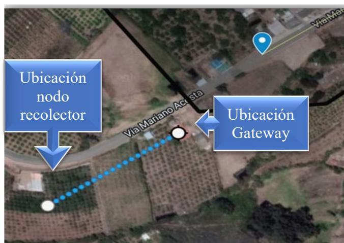
El nodo recolector de datos es instalado en el cultivo de manzano, a 1 metro de la base de los árboles, el dispositivo electrónico se encuentra en la parte interna de la casa y el sensor enterrado a 30 cm sobre el nivel del piso, la altura del módulo LoRa sobre el nivel del piso es de 1 metro, tal como se muestra en la Figura 76.
