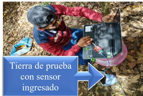
Es así como se puede mostrar los datos medidos por el sensor, en el monitor virtual del computador de prueba, según la denominación NPK, para efecto de prueba de funcionalidad se especifica la hora de toma de datos, la denominación, el valor recolectado y su respectiva unidad, de esta manera se evidencia el dato con la marca temporal habilitada, pudiendo comparar el sincronismo del dato, tomando como referencia el dato a las (12:03:18) tal, como se muestra en la Figura 68.
