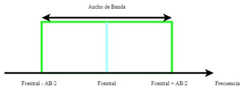
Debido a esto la velocidad de datos depende del ancho de banda utilizado y del factor de dispersión, LoRa puede usar canales con un ancho de banda de 125 kHz, 250 kHz y 500 kHz, según la región o el plan de frecuencia de operación, tal como muestra la Figura 5. El factor de dispersión se configura en la transmisor y receptor de datos, e influye en el tiempo que se tarda en transmitir una trama.
