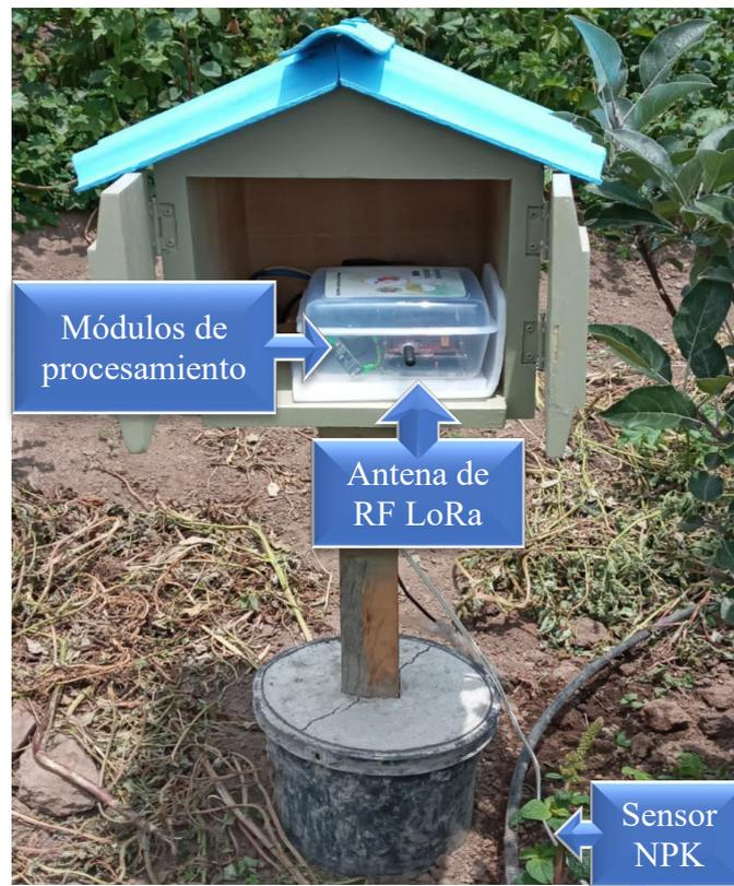
Para que el sensor pueda tomar los datos correctamente se debe enterrar a una profundidad de 30 cm sobre el nivel de la superficie, donde no afecte la radiación solar directa, posterior a eso las agujas que se encargan del censado deben ser ubicadas de manera horizontal, es importante que la tierra presente una contextura suave y libre de material rocoso, tal como muestra la Figura 79.
