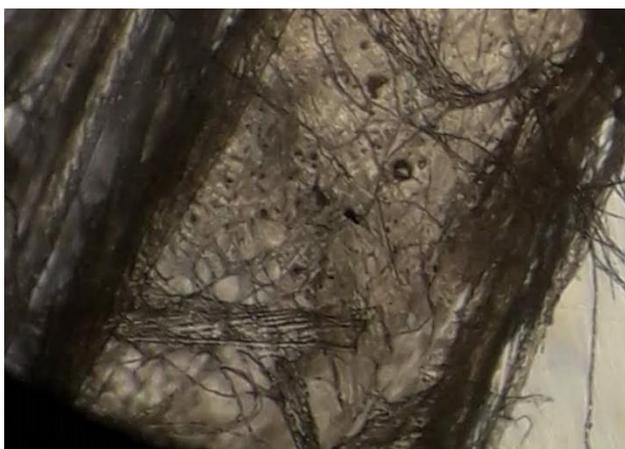
**Figura 28.** Estructura adsorbente presente en la pluma tratada
