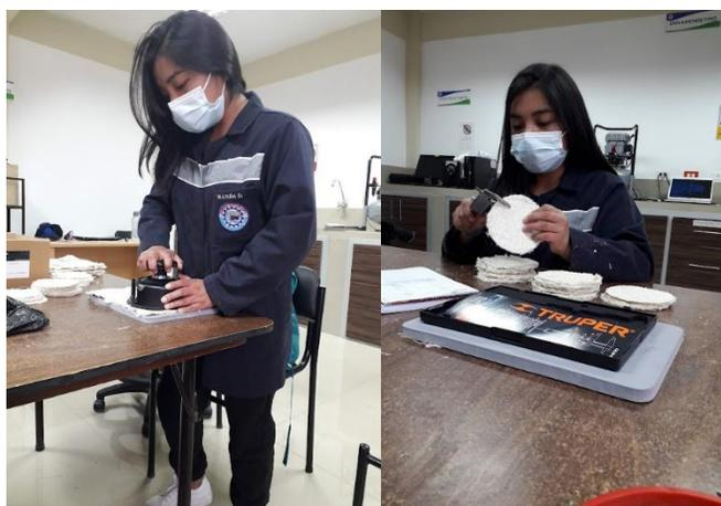
**Figura 31.** *Determinación de gramaje y espesor.*
