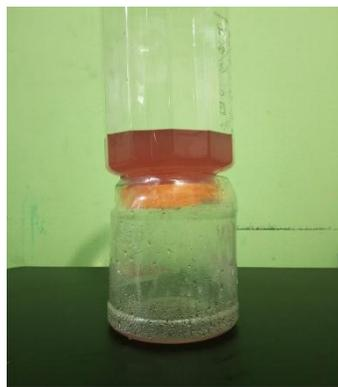
**Figura 35.** *Filtración por gravedad.*
