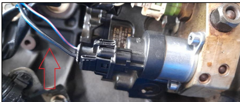
Figura 3.1 Cables de la válvula dosificadora de combustible
