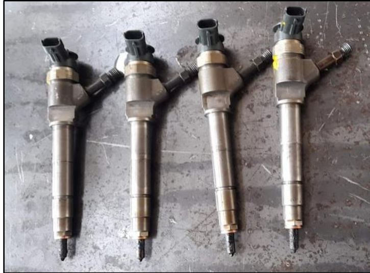
Figura 3.2 Inyectores diésel electrónicos bobinados
