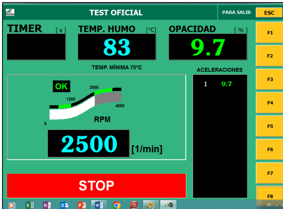
Figura 3.36 Medición de opacidad a 2500 rpm con el equipo Brain Bee OPA-100
