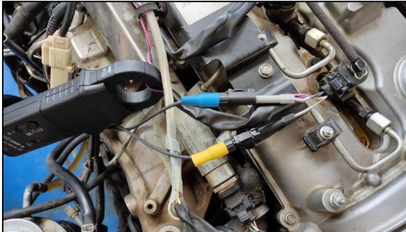
Figura 2.12 Conexión de agujas de medición y la pinza amperimétrica en un inyector
