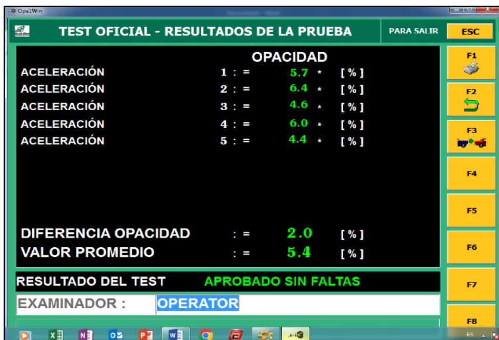
Figura 3.21 Niveles de opacidad a 2500 rpm con la válvula dosificadora de combustible normal
