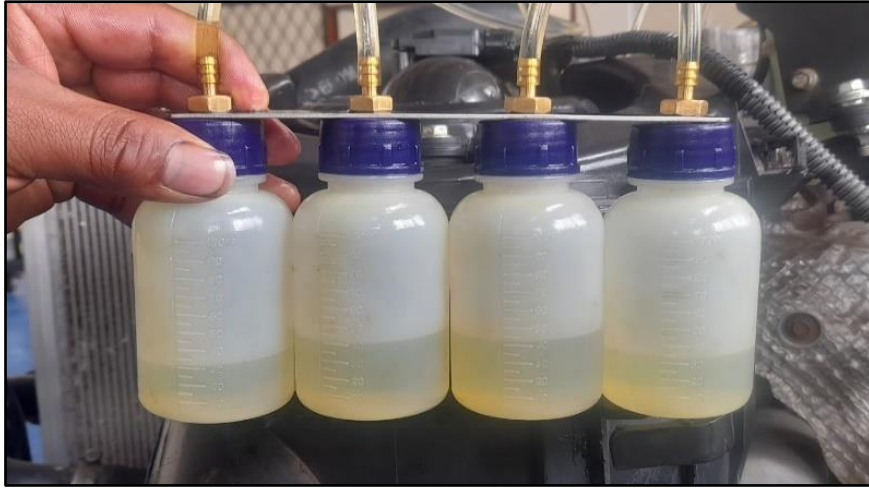
Figura 3.24 Prueba de retorno de combustible con variación de la presión de combustible en el riel con una presión de 61,70 MPa
