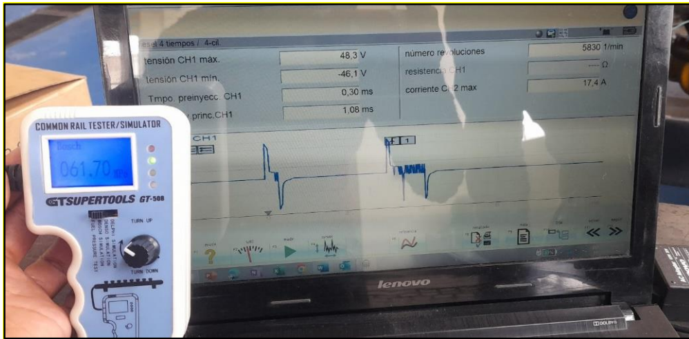
Figura 2.22 Simulación de señal de falla en inyectores Common Rail
