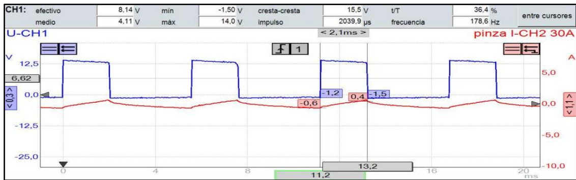
Figura 3.5 Oscilograma de la válvula dosificadora de combustible a 2 500 rpm
