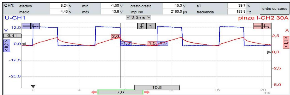
Figura 3.4 Oscilograma válvula dosificadora de combustible ralentí
