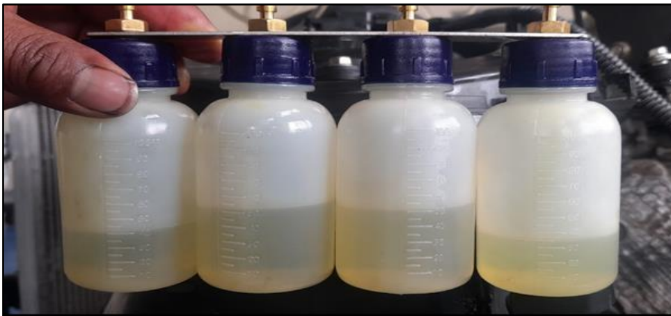
Figura 3.23 Prueba de retorno de combustible con inyectores diésel defectuosos
