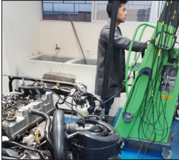
Figura 2.23 Obtención de señales de falla en inyectores con el equipo FSA 740
