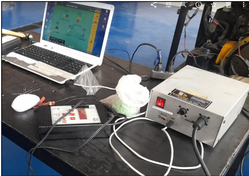
Figura 2.18 Conexiones del opacímetro
