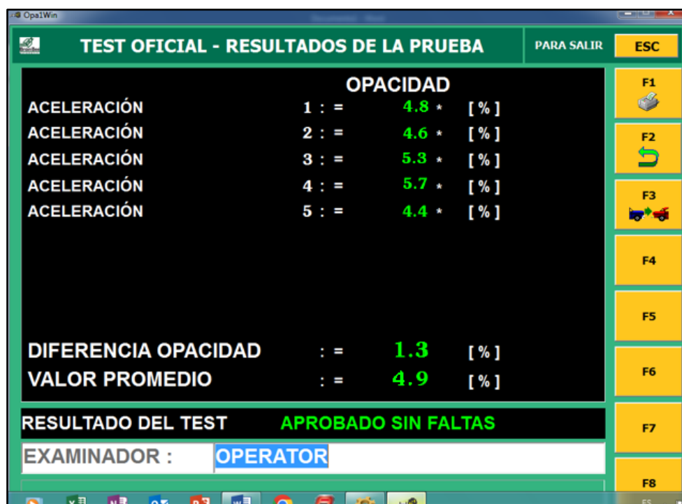
Figura 3.22 Niveles de opacidad a 2500 rpm con falla en la válvula dosificadora de combustible
