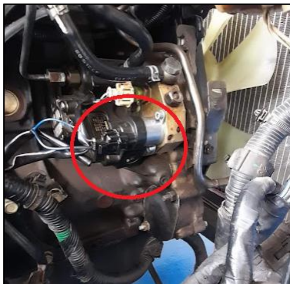
Figura 2.9 Ubicación de la válvula dosificadora de combustible
