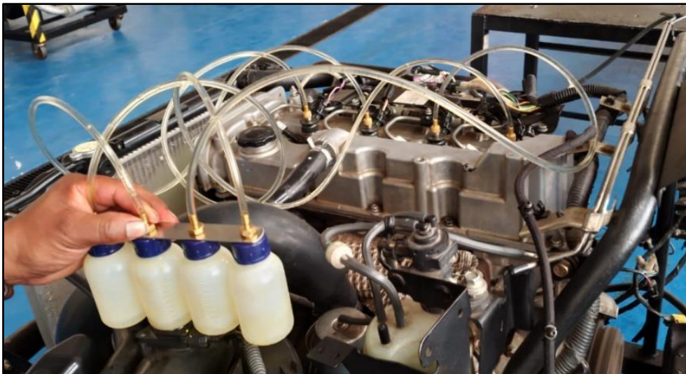
Figura 2.1 Conexión para la prueba de retorno de combustible en inyectores diésel
