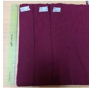
*Nota:* Se determinó el tamaño de las probetas (38cm\*30cm) en función de que, las piezas tienen que cumplir las medidas establecidas para las pruebas en el Spray Tester y para el molde de la pieza absorbente del panty. Para calibración del foulard se usó probetas de 15cm\*30cm.
