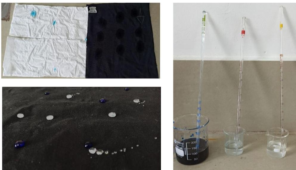
*Nota:* La imagen superior izq es el tejido de la capa 1 y el inferior es el tejido de la capa 3. Las soluciones de izq a derecha son: simulación de flujo, agua, agua destilada. Fuente: Propia
