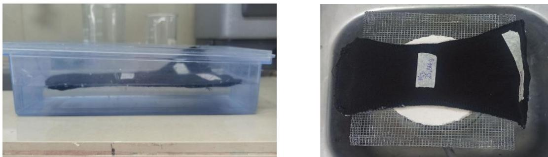
*Nota:* Se observa al material protector reposando en la solución salina y drenando sobre la rejilla. Fuente: Propia
