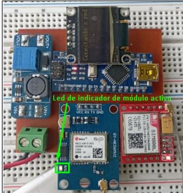
**Figura 35.** Módulo GPS NEO6m en estado activo, vista superior.
