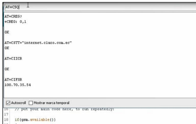
**Figura 56.** Prueba de conexión a la red móvil mediante comandos AT.
