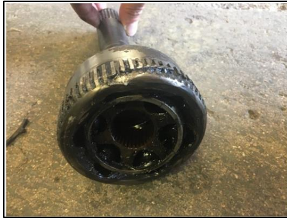
Figura 2. 21 Rotura Rueda Fónica homocinética
