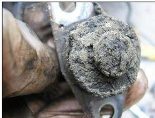
Figura 2. 20 Impurezas en el sensor ABS
