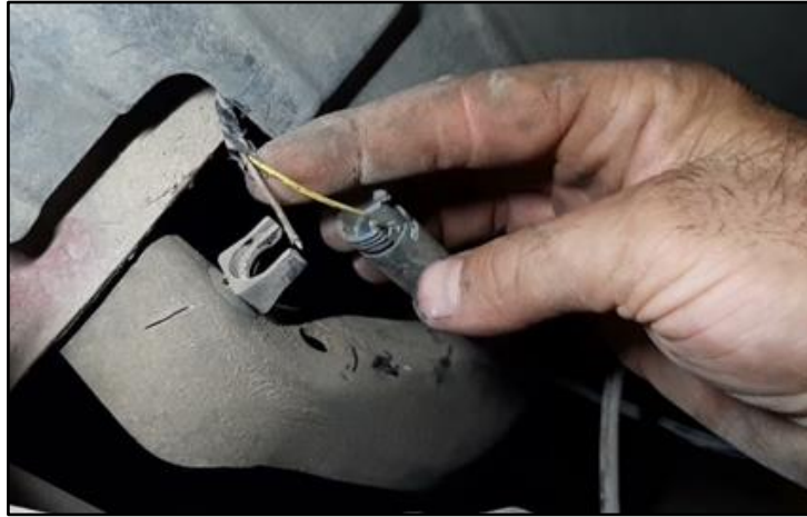
Figura 2. 22 Rotura de cableado sensor ABS por fatiga.
