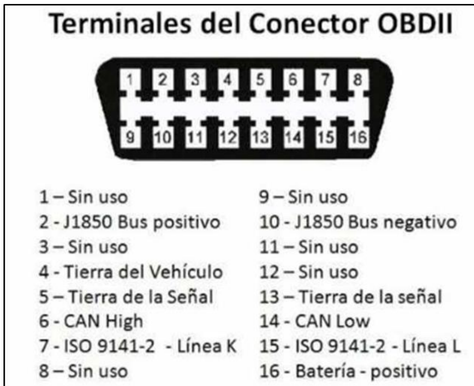
Figura 2. 14 Representación gráfica del conector OBD II (CAN-BUS Archivos - INGENIERÍA Y MECÁNICA AUTOMOTRIZ, n.d.)
