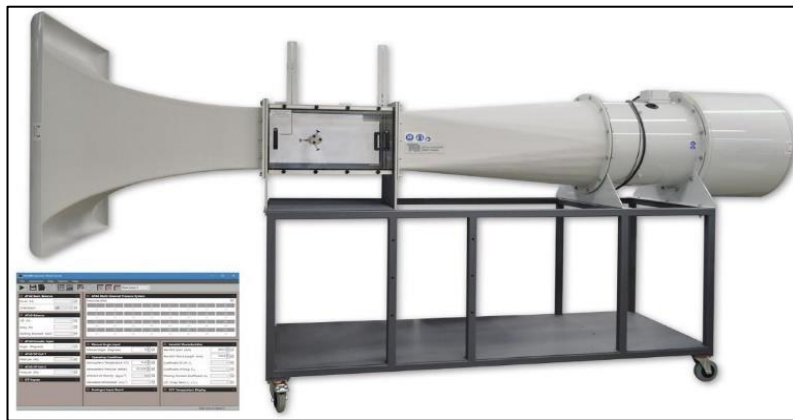
Figura 1-3. Túnel de viento Subsónico. (Alejandro Arango Duque, 2014)
