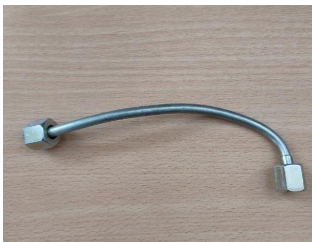
Figura 2.3: Cañería de alta presión
