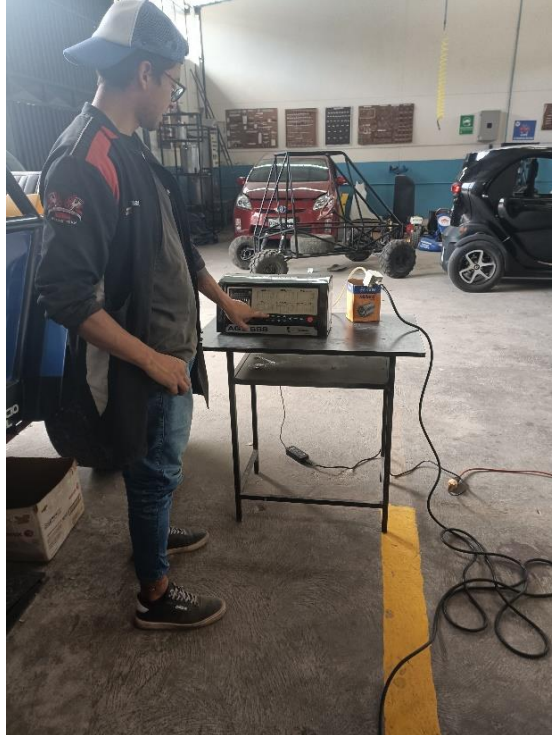
Anexo IV.1. Preparación del equipo analizador de gases
