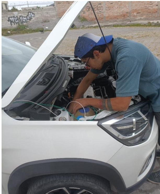
Anexo V.2. Conexión del sensor Knock al osciloscopio
