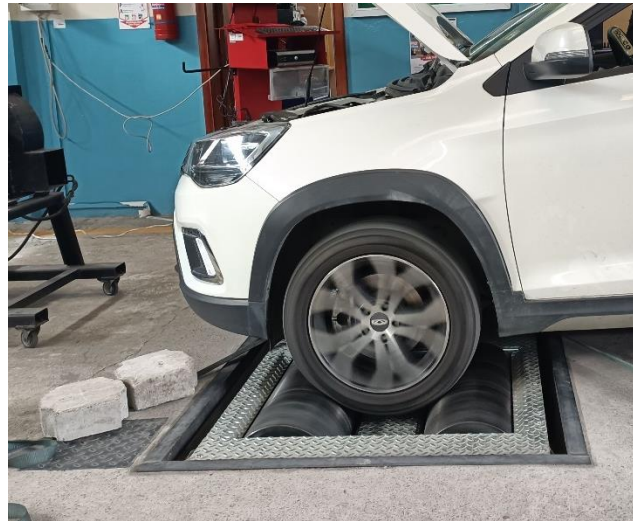
Figura 2.5 Dinamómetro Dyno Vamag
