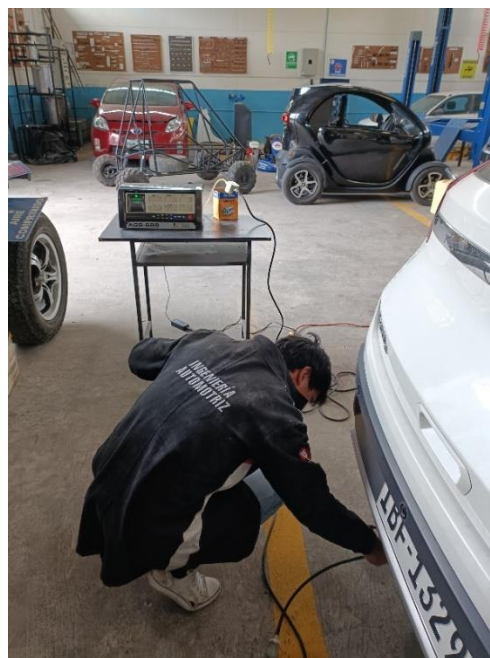
Anexo IV.2. Conexión de la sonda para medición de gases
