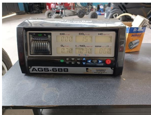
Figura 2.6 Analizador de gases Brain Bee AGS-688
