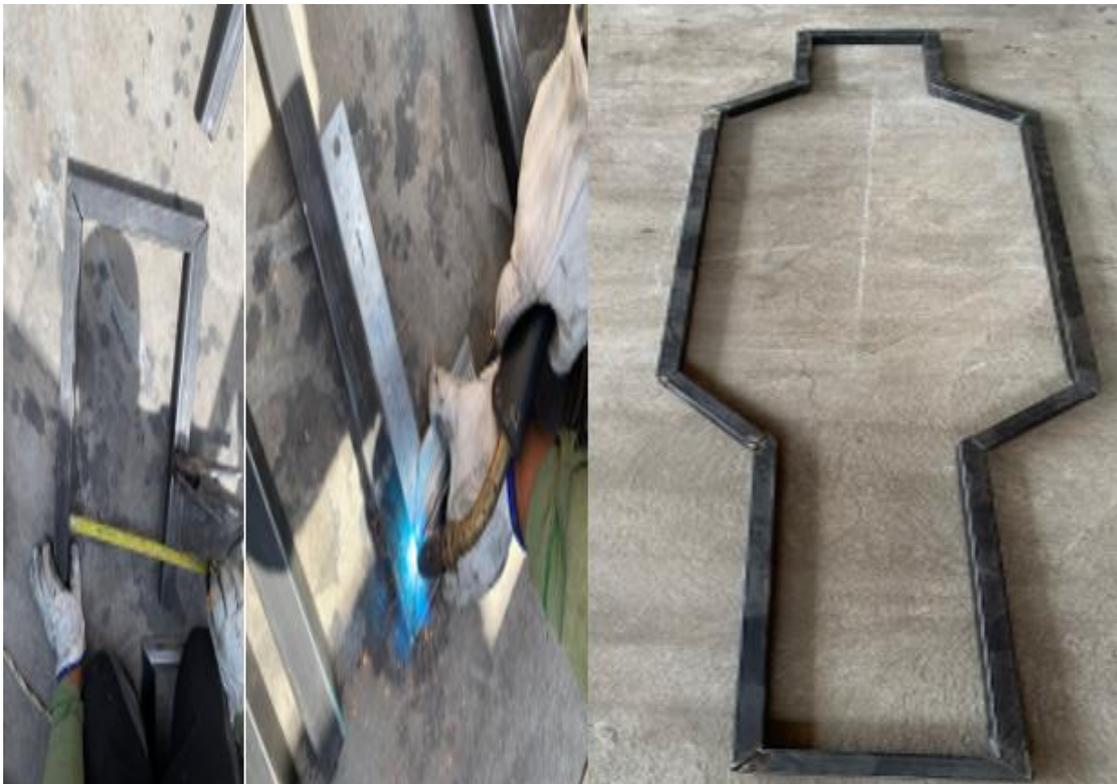
**Figura 3.67.** Construcción de la base del chasis.
