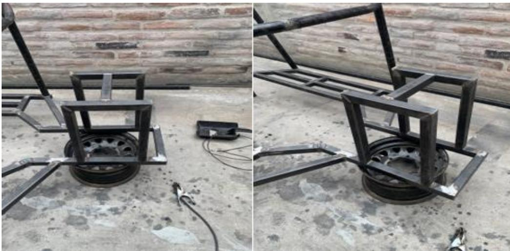
**Figura 3.69.** Construcción de la parte delantera del chasis
