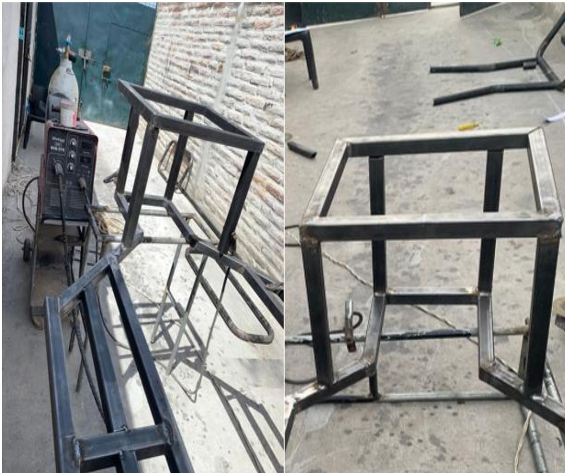
**Figura 3.70.** Construcción de la parte posterior o cajón del chasis.
