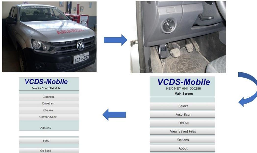
**Figura 2. 6** Conexión del equipo de diagnóstico VCDS-Mobile
