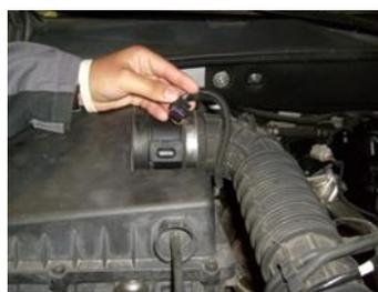
**Figura 3. 4** Sensor MAF desconectado
