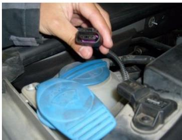
**Figura 3. 8** Sensor de presión de entrada del turbo desconectado
