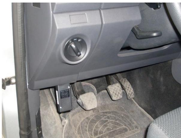
**Figura 3. 1** Ubicación y conexión del módulo VCDS-Mobile
