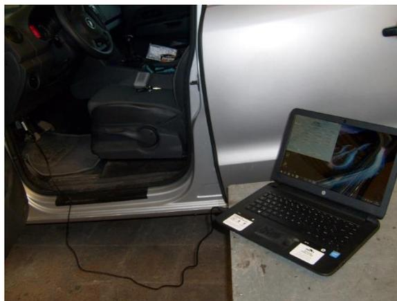
**Figura 3. 2** Conexión con el software de diagnóstico VCDS
