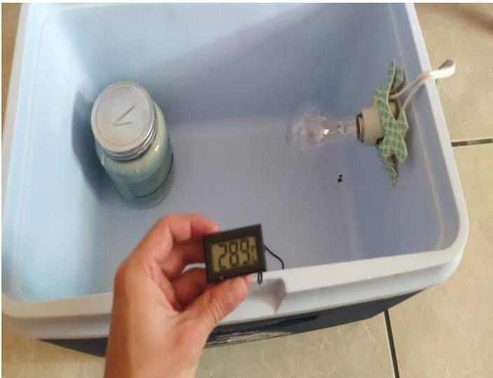
Nota: En el gráfico se observa la incubadora casera adaptada en una hielera con una bombilla y un termómetro de sonda para medir la temperatura interna
