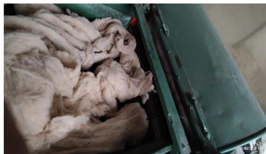
Con el material obtenido de la abridora, se alimenta a la carda como se indica en la **Figura 8**. En donde “su objetivo es paralelizar las fibras de forma sucesiva hasta conseguir una masa de fibras limpias y ordenadas en forma de cintas o mechas”(D. Esparza, 2013). Para esta investigación se obtuvo un velo el cual se lo coloca en los conos que se encuentran en la parte
