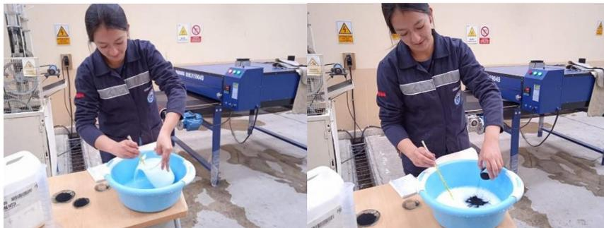
4. Una vez mezclado se sumerge el filtro de lana y se lo pasa por los rodillos del foulard con la presión de 1 bar para retirar el exceso de agua del filtro.
