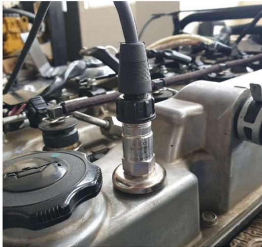
**Figura 2.15** Sensor 1-vertical instalado
