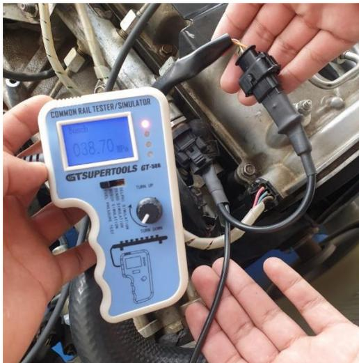
**Figura 2.19** Simulador GT-508 instalado
