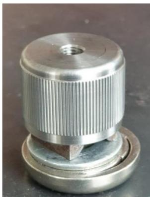
**Figura 2.5** Imán usado para montaje de sensor sobre el motor
