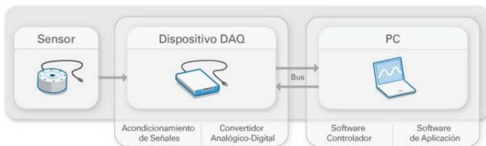
**Figura 2.10** Proceso metodológico para la adquisición de datos a partir de las vibraciones
