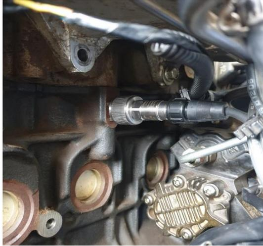
**Figura 2.14** Sensor 0 - horizontal instalado
