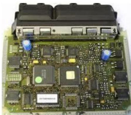
**Figura 1.7 Unidad de control electrónica**
