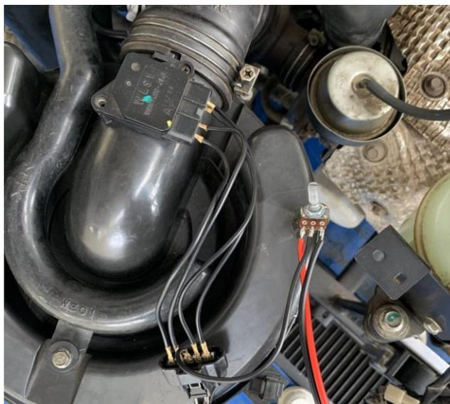
**Figura 2.20** Conexión para variación de señal del MAF
