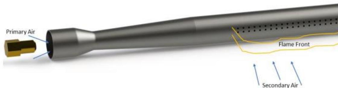
*Figura 28 Quemador atmosférico [34].*
