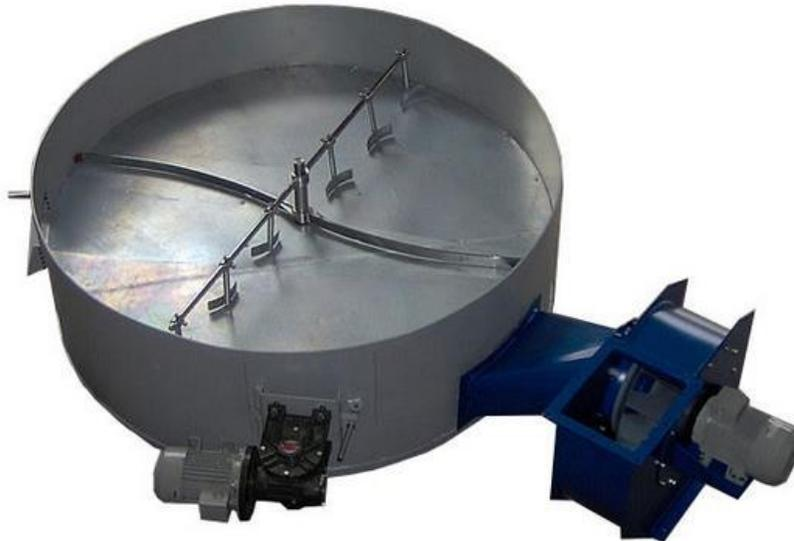
*Figura 9 Secadora de cacao cilíndrica [5].*
