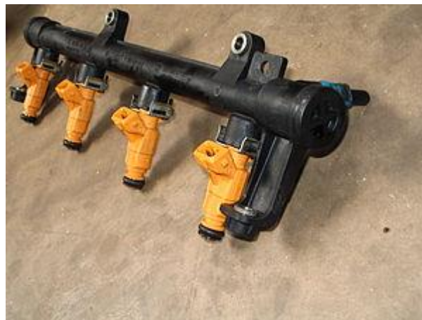
FIG. 3 INYECTORES, CON SU RAMPA DE ALIMENTACIÓN
