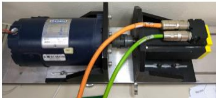
Figura 4. MSIP empleado (izquierda) y motor de CD usado como carga
