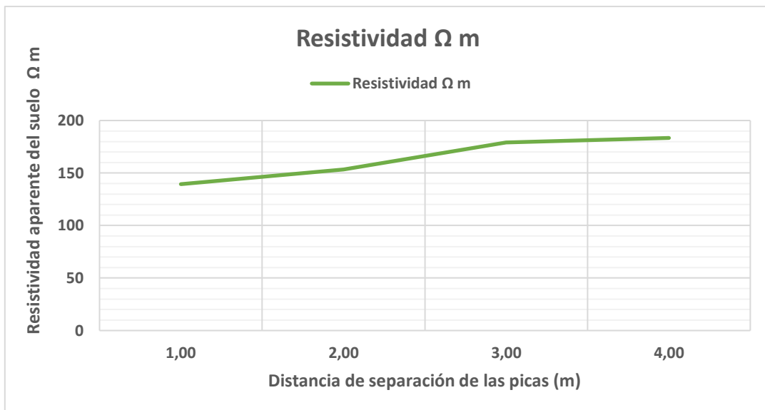
Figura. 62: Curva de la resistividad aparente del suelo
