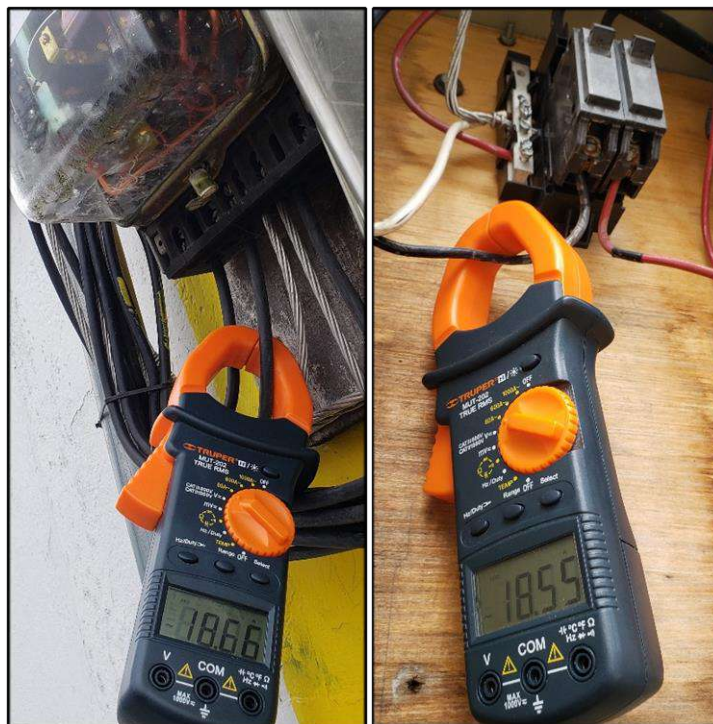
Figura. 25: Comparación de corriente en las fases con un Multímetro
