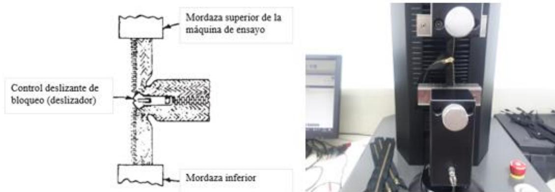
*Nota:* Colocación de la cremallera entre las mordazas del dinamómetro previo al ensayo de resistencia del deslizamiento del seguro. *Fuente:* (ICONTEC, 2013b)
