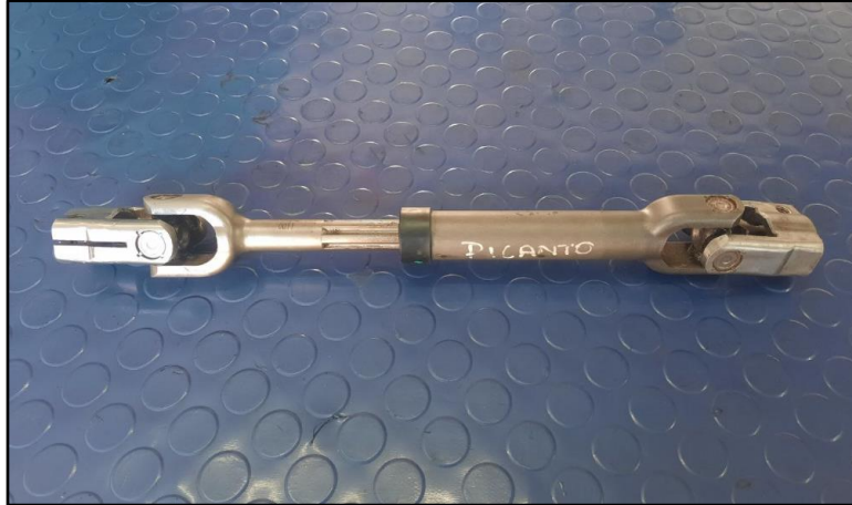
Figura 2.28 Muñón de la columna de dirección del Kia Picanto
