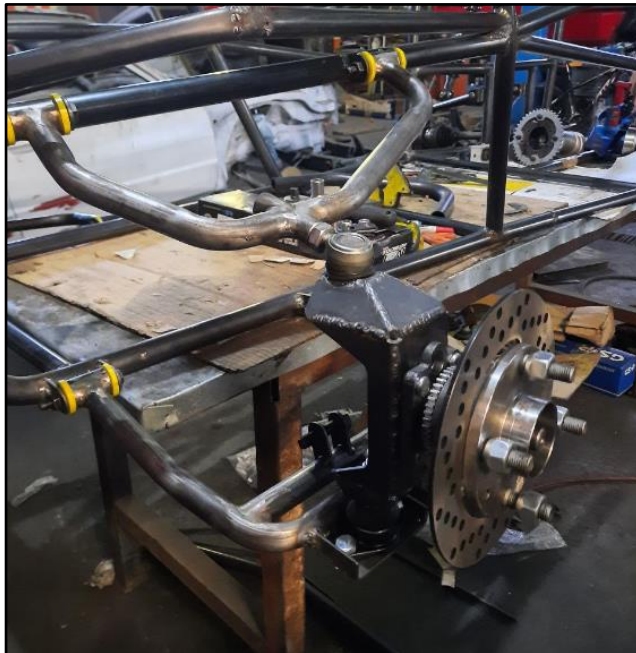
A II 3 Mesa, Mangueta, Manzana y Disco de freno Ensamblados
