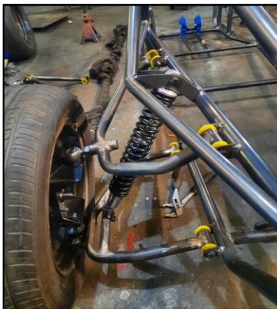
Figura 3.13 Ensamblaje del amortiguador como elemento de suspensión
