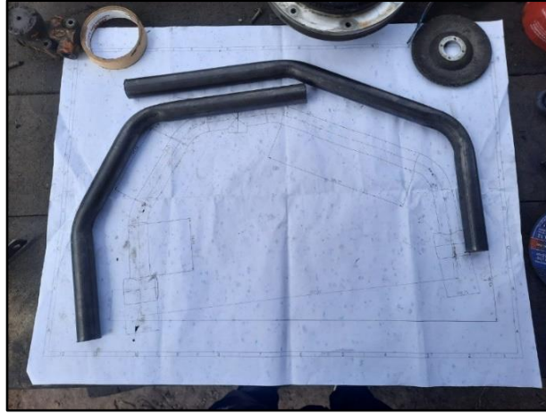
Figura 2.21 Tubos doblados de la mesa de suspensión superior
