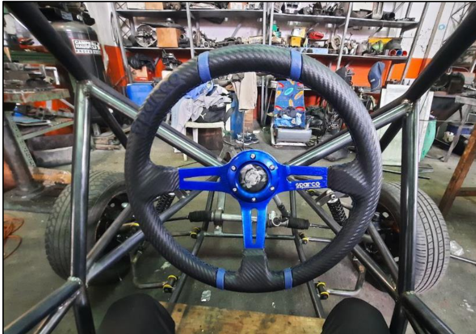
Figura 2.30 Volante anclado a la placa base
