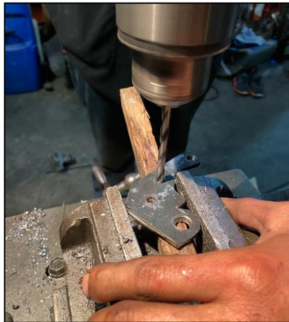
Figura 2.33 Construcción molde de la placa de sujeción
