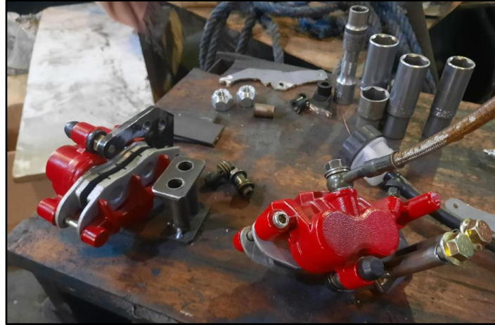
Figura 3.15 Mordazas de freno ensambladas con las placas de sujeción modificadas
