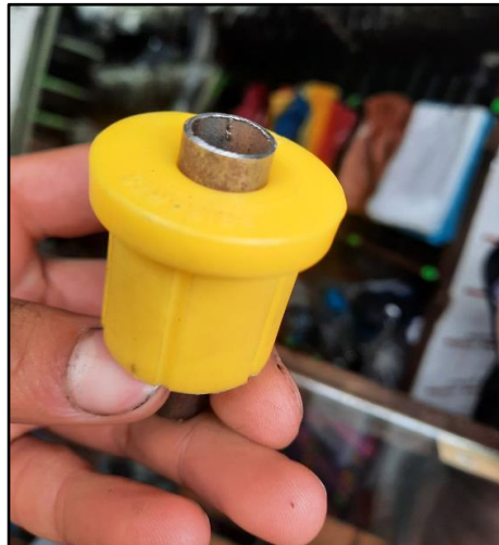
Figura 2.23 Caucho con tubo interno para los bujes de las mesas de suspensión
