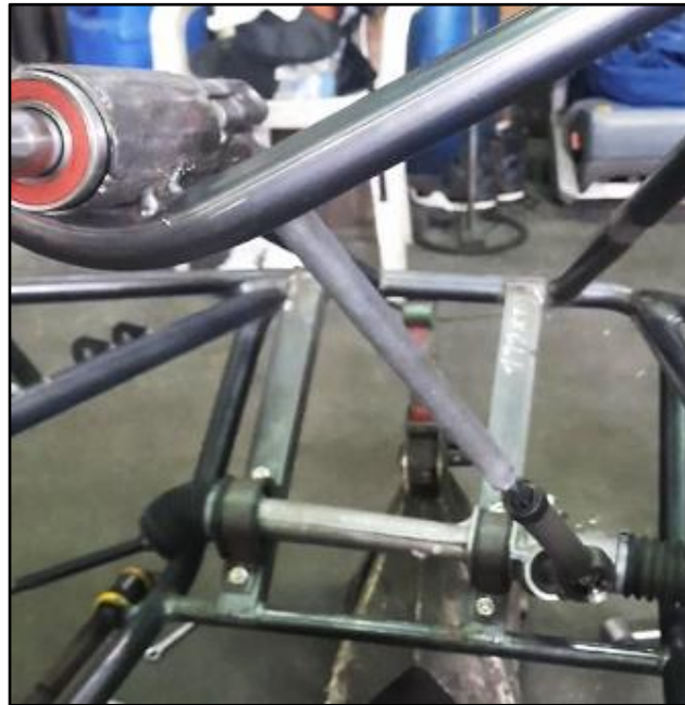
Figura 2.29 Sistema de rodamientos para la columna de dirección
