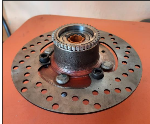
Figura 2.31 Disco de freno adaptada a la manzana
