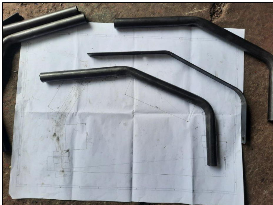
Figura 2.20 Molde de la platina y tubo doblado
