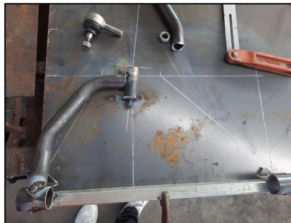
Figura 2.22 Matriz para soldar la mesa de suspensión superior
