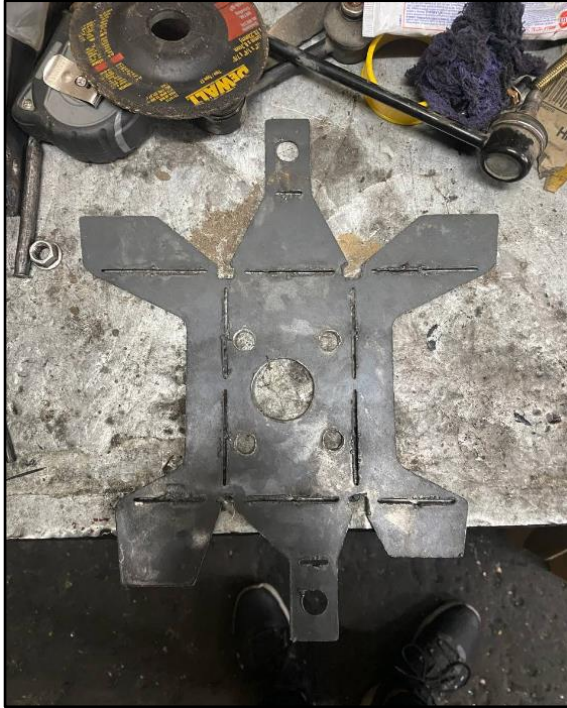
A II 2 Mangueta Fabricada por Corte CNC
