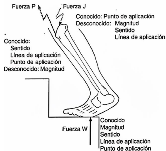
Figura 1. 10 Diagrama de cuerpo libre de articulación de rodilla [5].
