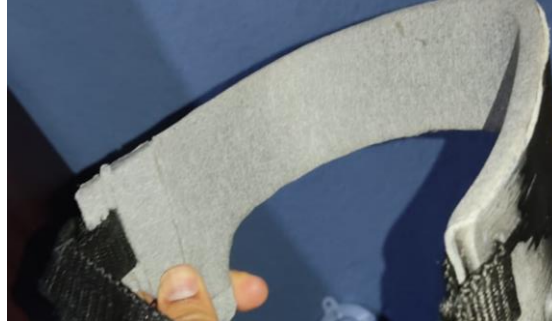
Figura 3. 44 Recubrimiento de férulas con neopreno de 2mm.
