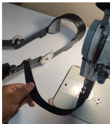
Figura 3. 43 Confeccionado de cuerdas de ajuste y sujeción, máquina industrial SIRUBA recta L918 cocida con hilo negro normal a 0.6mm de diámetro.
