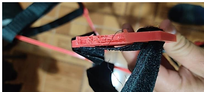
Figura 3. 46 Ruptura en zona crítica.
