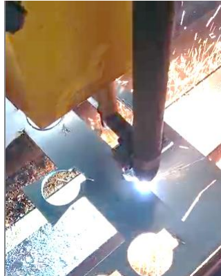
Figura 3. 41 Corte por plasma de relieve de goniómetro, 10ga de espesor, 190 ipm de velocidad, 3mm de espesor.
