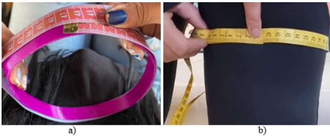
Figura 3. 11 Comparación de medidas zona 2; a) Fotogrametría (465mm), b) Real (468mm).
