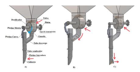
El funcionamiento es impulsado por un mecanismo de transmisión de potencia catalina - piñón descrito en el punto 4.4.3, que permite el movimiento de un eje cilíndrico que da movimiento al sistema dosificador y de siembra:
