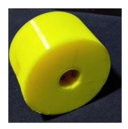
La Figura 4.26, muestra el elemento encargado de distribuir la cantidad correcta de semillas por cada giro de 360°, fue elaborado en una impresora 3D "Artillery Genius pro" que se caracteriza por su mejor control del filamento flexible permitiéndole obtener mejores resultados de una forma más sencilla. Para laminar el dosificador se utilizó el software "SIMPLIFY 3D" dándole las siguientes configuraciones:
