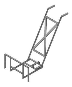
El chasis que se muestra en la Figura 4.23, es la unión del bastidor con el sistema de empuje, en conjunto forman una estructura metálica completa capaz de encajar y soportar los diferentes elementos que conforman la máquina. Los materiales que se usó para su construcción se encuentran detallados en la Tabla 4.15.
