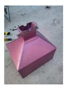
Para fijar las partes de la tolva se utilizó la soldadura por puntos con el electrodo para acero inoxidable E-308L-16.
