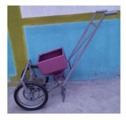
En la Figura 4.29 se observa todos los elementos ya ensamblados, adicionalmente se colocó una capa de pintura de color plateado a la estructura y otros materiales. Se decidió sombrear con pintura METALTEC de PINTUCO ya que otorgaba una buena protección contra las condiciones climáticas.
