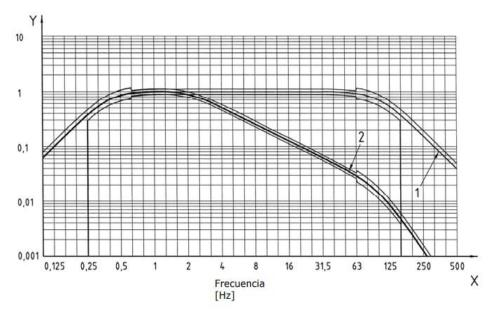
Nota. Adaptado de Manual del usuario. Filtro de ponderación Wd (p.133), por Delta OHM HD2030,(2014), Fuente: (manualslib.es/manual/388029/Delta-Ohm-Hd2030.html). CC.
