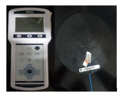
Nota. Vibrómetro HD2030 y acelerómetro triaxial [Fotografía]. Fuente: Elaboración propia.
