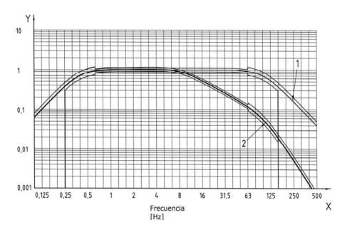
Nota. Adaptado de Manual de usuario. Filtro de ponderación Wc (p.133), por Delta OHM HD2030,(2014), Fuente: (manualslib.es/manual/388029/Delta-Ohm-Hd2030.html). CC.
