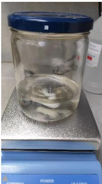
Nota: Agitación de la mezcla NaOH/ Metanol para su disolución.
