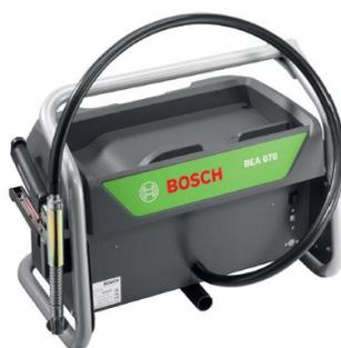
Nota. Vista general del equipo para medición de opacidad en motores Diésel BEA 070. Fuente: [37]
