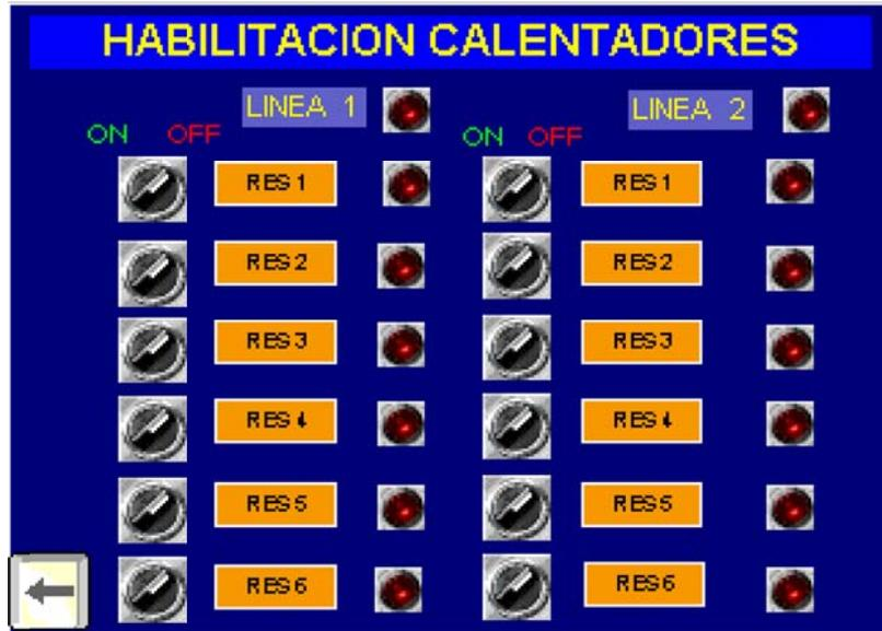
Figura 2.21 Calentadores del tercer proceso del sistema de control de temperatura del bunker del tren T07
