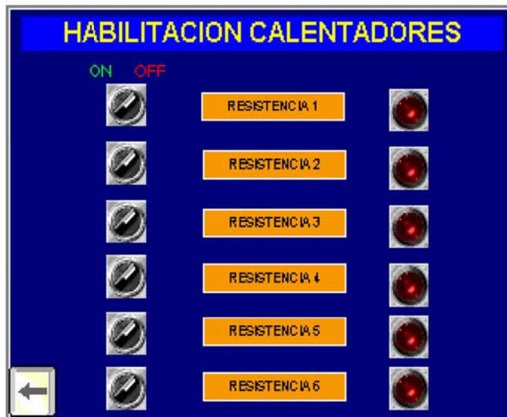
Figura C.4 Pantalla de habilitación de calentadores del Primer proceso de calentamiento
