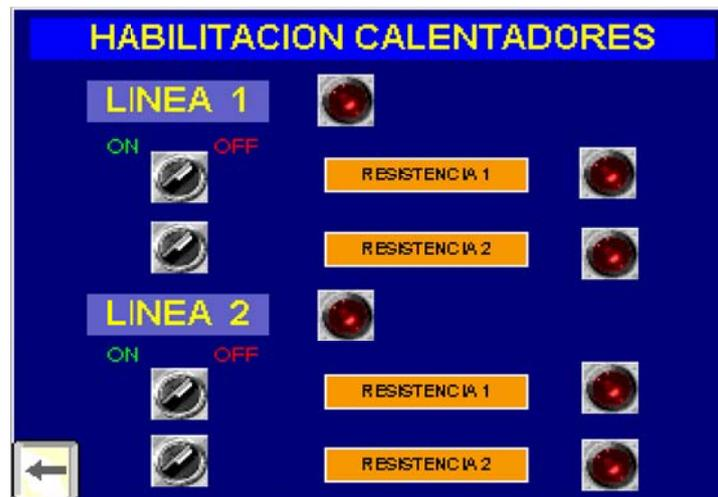
Figura 2.19 Calentadores del Segundo proceso del sistema de control de temperatura del bunker del tren T07
