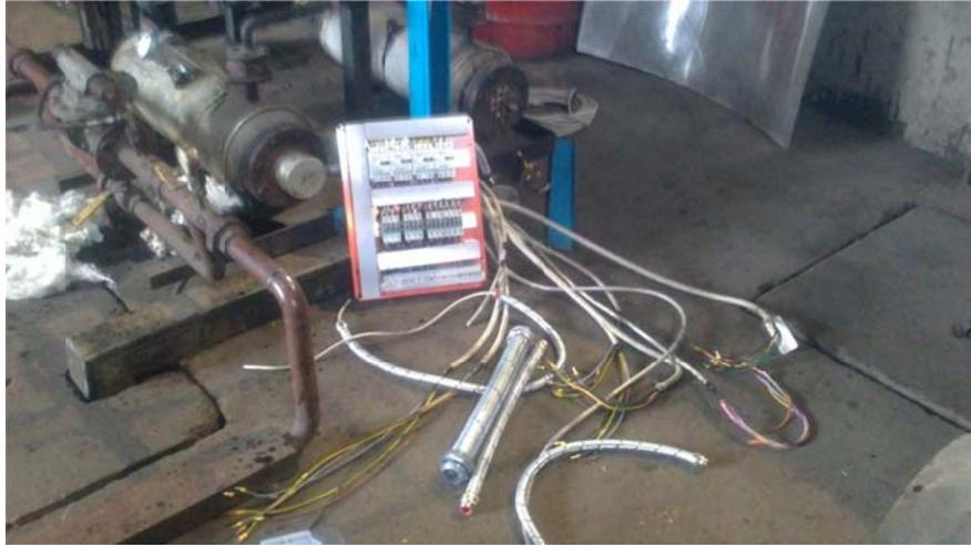
**Figura 3.11 Cableado del sistema de control de calentamiento de combustible del T07**
