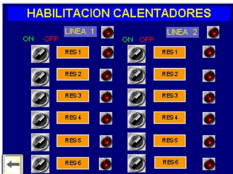
Figura B.8 Pantalla de habilitación de calentadores del Tercer proceso de calentamiento
