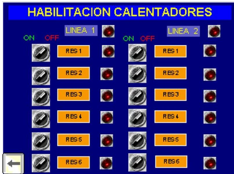
Figura C.8 Pantalla de habilitación de calentadores del Tercer proceso de calentamiento
