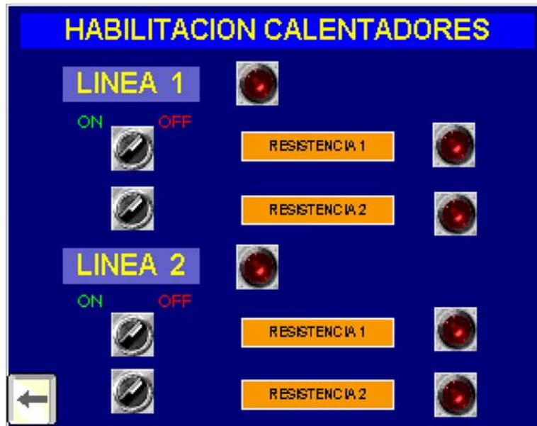
Figura C.6 Pantalla de habilitación de calentadores del Segundo proceso de calentamiento
