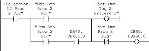
Segm.: 17 Limite Temperatura Manual Con Histeresis Tanque 2 Proceso 2
