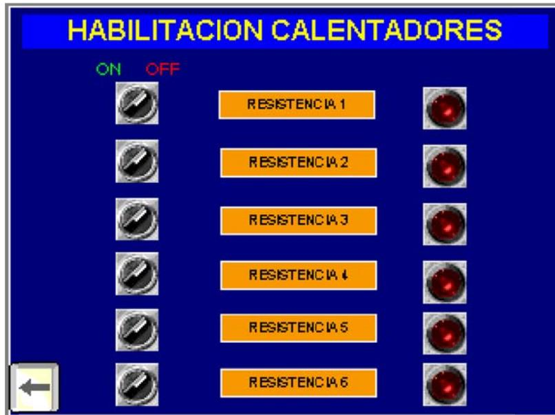
Figura 2.17 Calentadores del tanque principal del sistema de control de temperatura del bunker del tren T07
