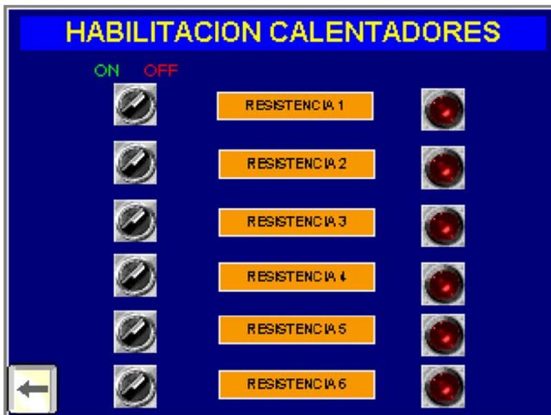
Figura B.4 Pantalla de habilitación de calentadores del Primer proceso de calentamiento
