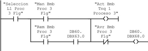
Segm.: 12 Limite Temperatura Manual Con Histeresis Tanque 1 Proceso 3
