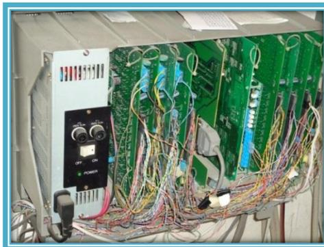
Figura 7. Central Telefónica Analógica, con sus respectivas tarjetas de expansión
