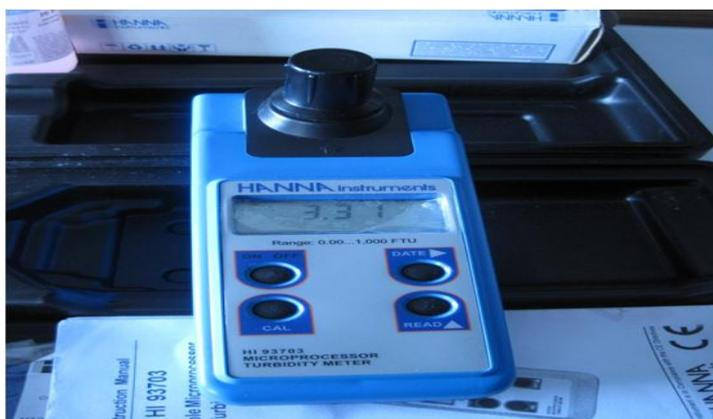
Fotografía 3.7: Equipo utilizado para medir la turbidez en el vinagre
