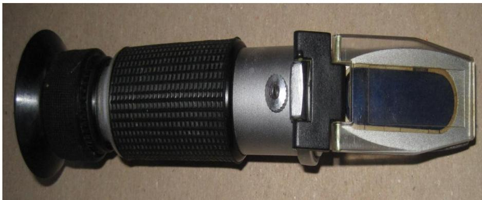
**Fotografía 3.3:** Refractómetro para determinar los grados brix
