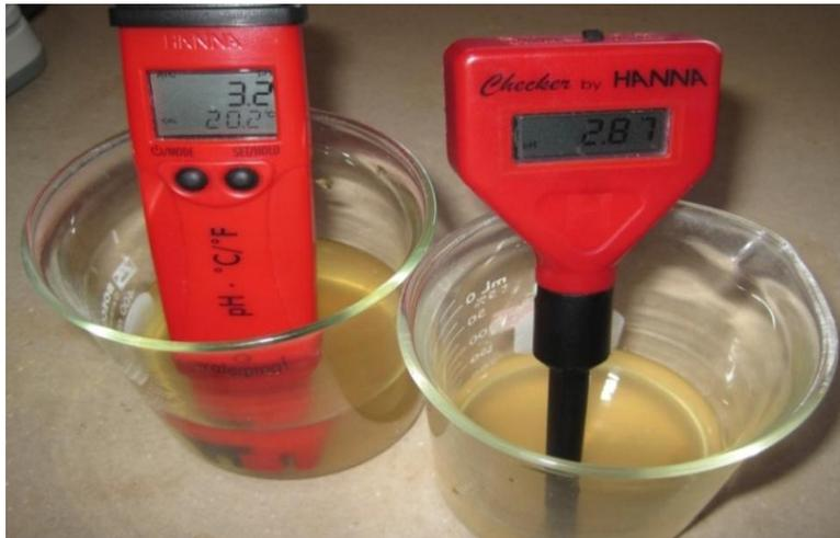
**Fotografía 3.2:** Equipo de pH y determinación de pH en el producto
