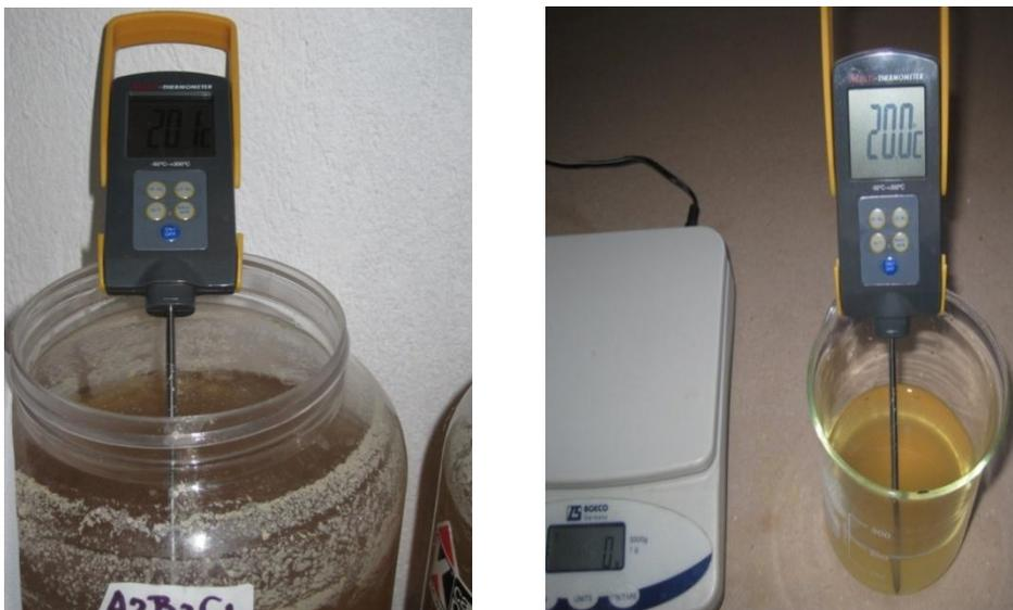
Fotografía 3.4: Determinación de temperatura en el proceso de acidificación
