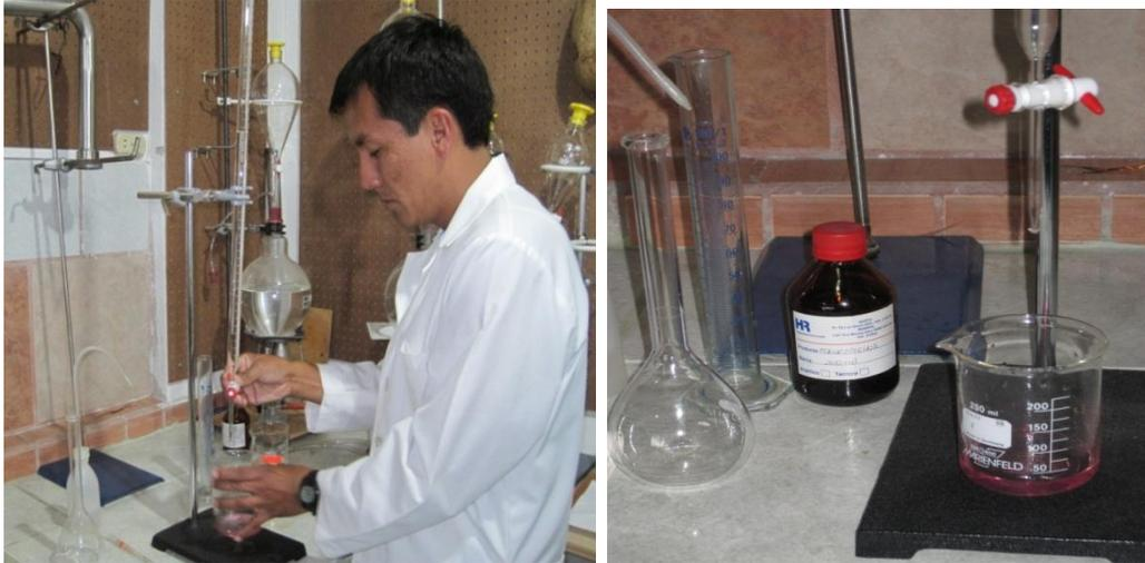
Fotografía 3.6: Experimentación en la determinación de acidez total del producto
