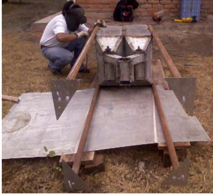
Figura 2. 27 Colocación de los soportes de la máquina.
