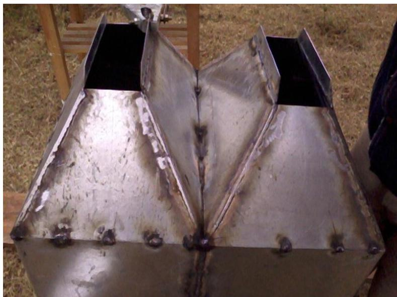
Figura 2. 22 Unión de partes de la tolva<sup>48</sup>
