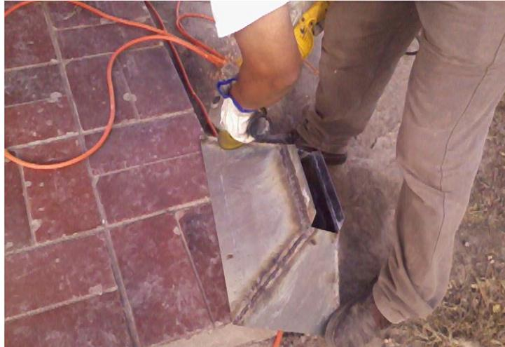
Figura 2. 21 Construcción de la parte inferior de la tolva<sup>47</sup>
