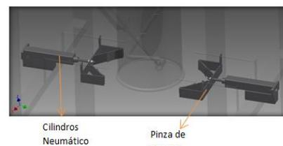
**Fig. 4** Mecanismo de ajuste de sacos
