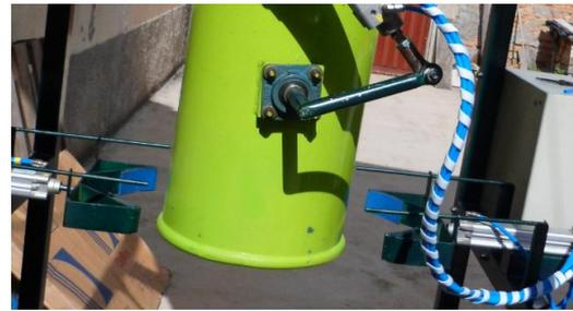
**Fig. 9** Mecanismo de sujeción de sacos
