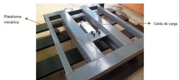
**Fig. 5** Plataforma de pesaje
