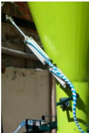
**Fig. 8** Mecanismo de cierre y apertura
