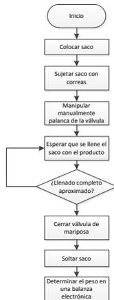
**Fig. 1** Diagrama pesaje y llenado manual de sacos de harina de 50 kg
