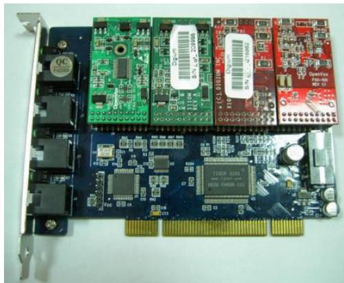
*Figura 60 Tarjeta Open Vox y Módulos FXO, FXS*
