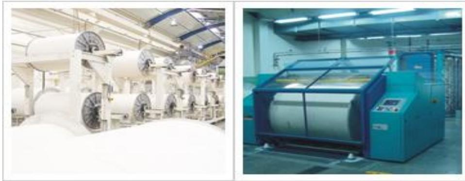
**Fig.1 Sistemas de Urdido y Engomado.**
