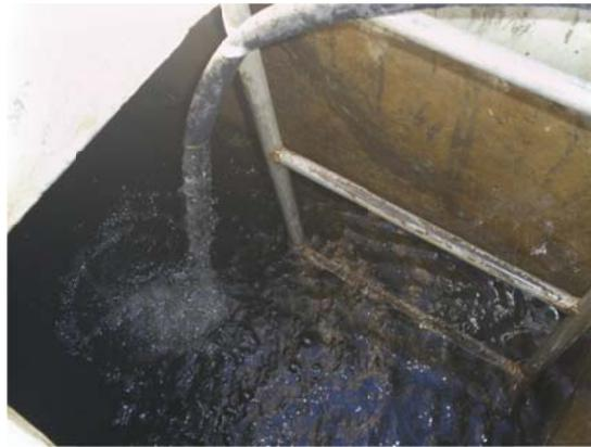
(Foto 10.3 Medición de caudal por método volumétrico).
