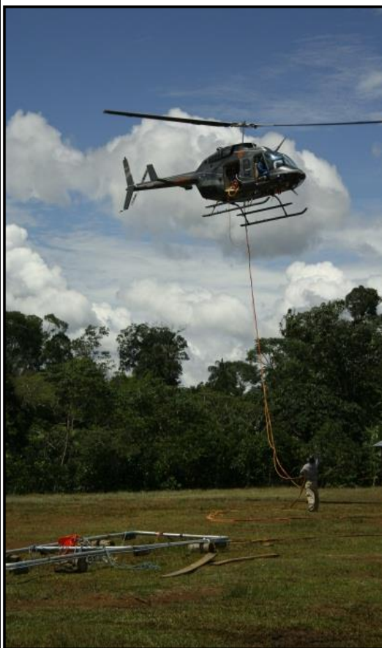
Fotografía 5. Acople del aguilón al helicóptero
