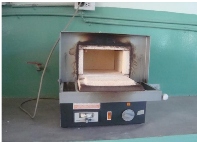
Fotografía 11. Medición de humedad
