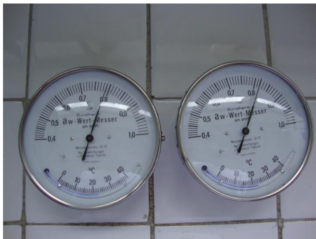
Fotografía 12. Equipo Aw- WERT-MESSER medición actividad de agua
