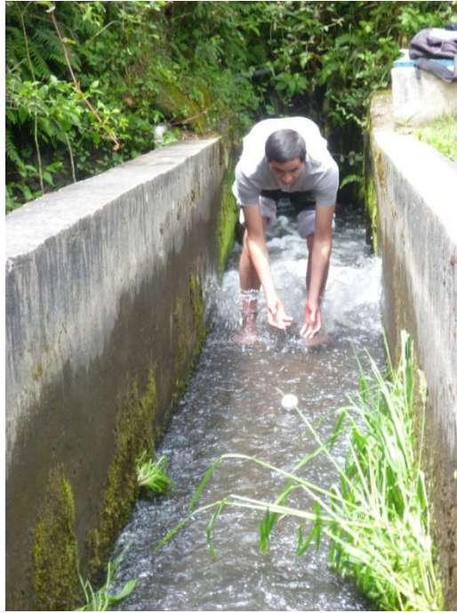
Foto 9: Aforo por método de flotador del canal
