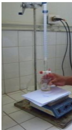
Fotografía 6. Equipo para medir acidez total
