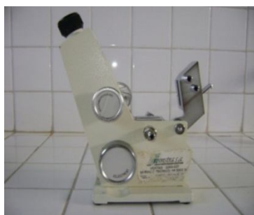
Fotografía 3. Refractómetro Abbé con escala de 0 a 32 °Brix
