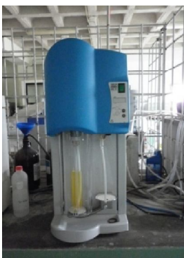
Fotografía 7. Destilador Velp UDK modelo 127
