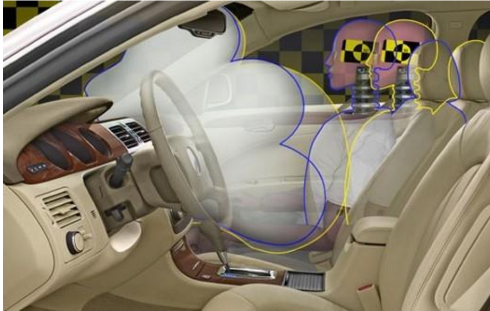
Fig. No. 17. Esquema del despliegue de AirBags delanteros
