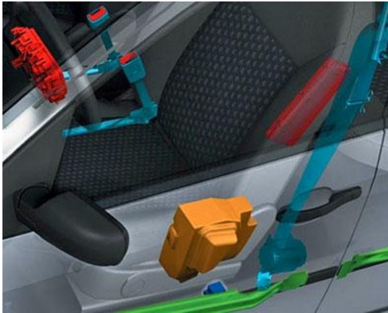
Fig. No. 11. Retractor automático del cinturón de seguridad
