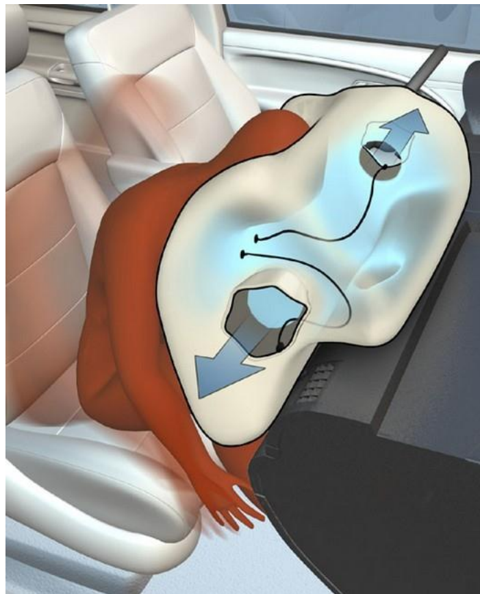
Fig. No. 16. Orificios de desfogue del AirBag
