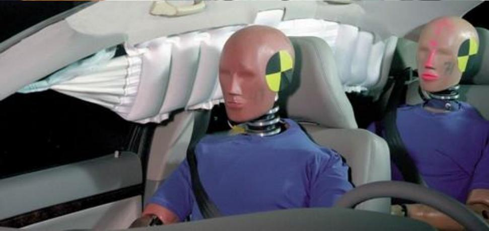
**El Airbag se acciona a una velocidad de 300 km/h.**
