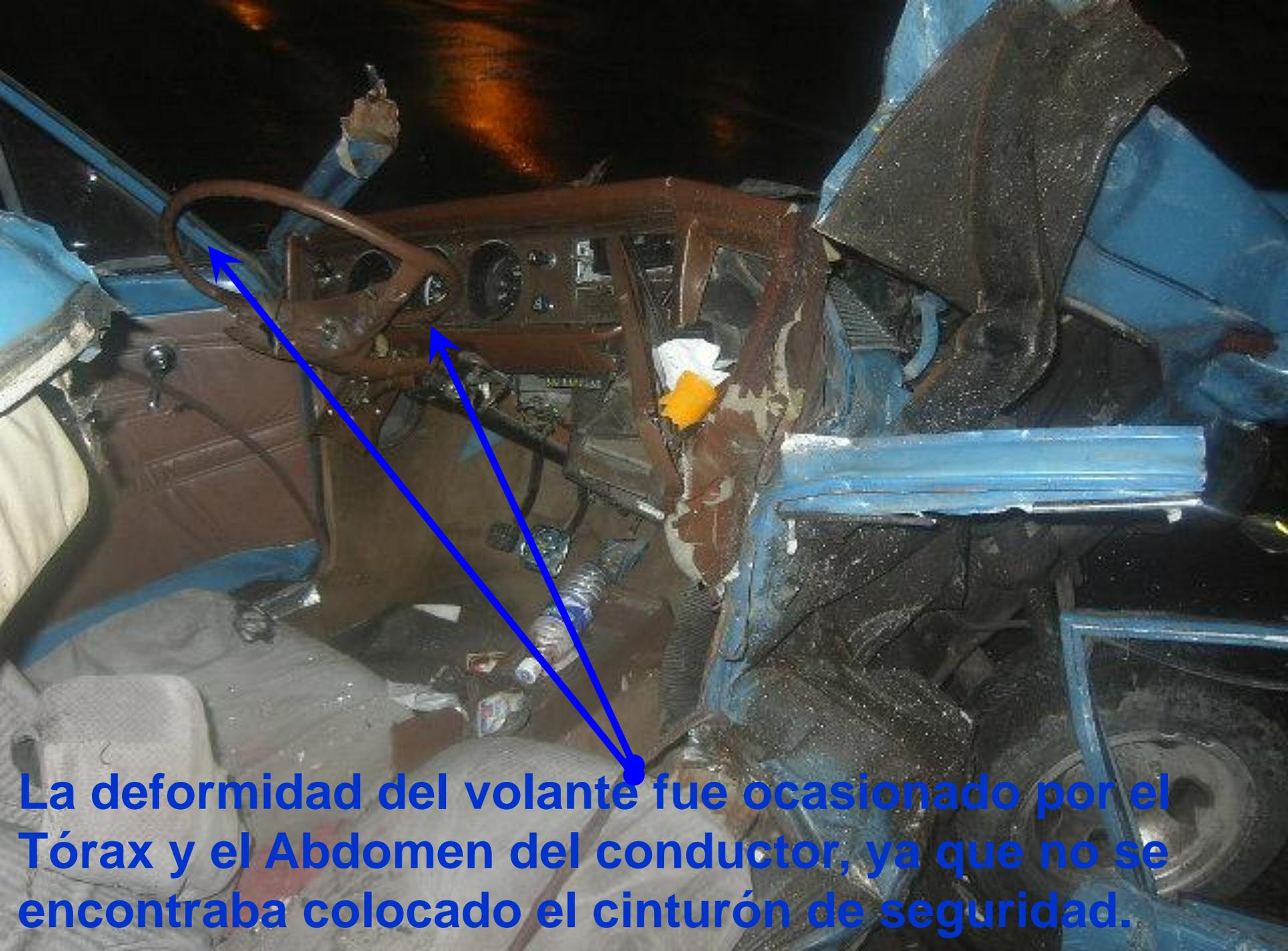
La deformidad del volante fue ocasionado por el Tórax y el Abdomen del conductor, ya que no se encontraba colocado el cinturón de seguridad.
