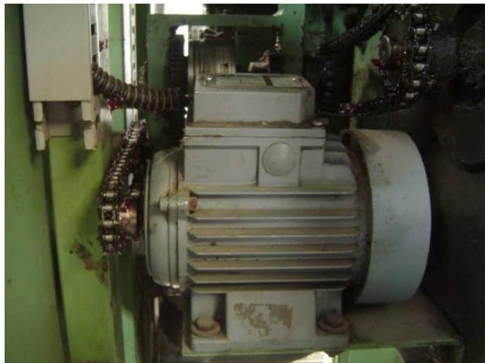
Fig. 100. Motor para ascenso y descenso de bancada.
