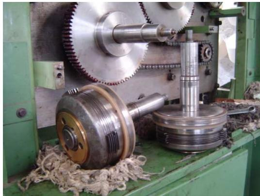
Fig. 103 Limpieza de las partes móviles de la máquina.
