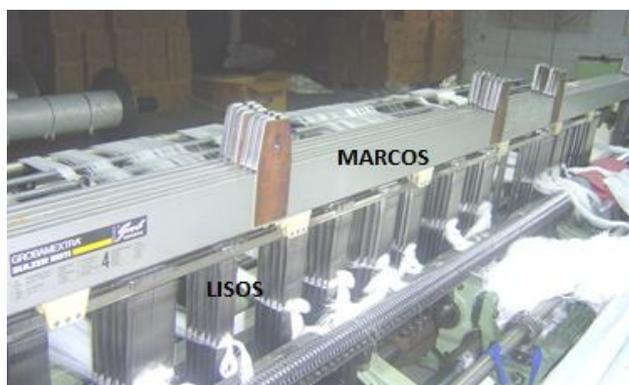
**Fig3. Proceso de Remetido (Se realiza por capas de hilos para facilitar el proceso).**
