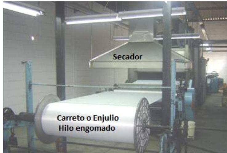
**Fig2. Engomadora (Hilo engomado secándose y pasando a enrollarse al Carreto).**
