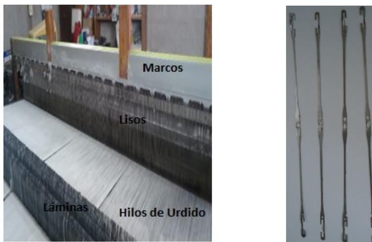
**Fig18. Marcos en el telar y tipos de lisos.**
