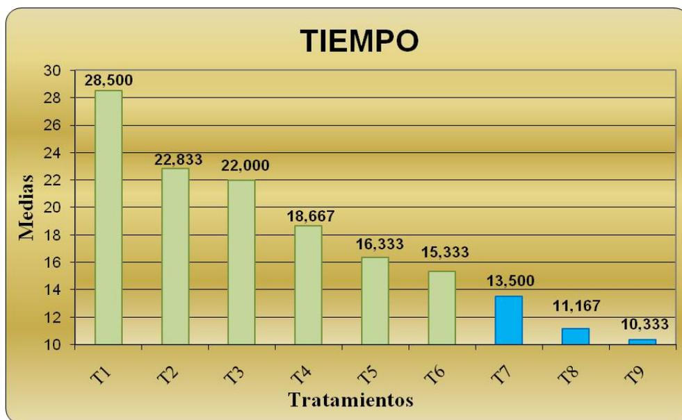
En el gráfico anterior, se observa que la temperatura de secado y el caudal volumétrico del aire en el secador influyen netamente en la variable tiempo, por lo que se aprecia que **T9** (temperatura de secado 55 °C y Caudal volumétrico del aire en el secador 0,0809m<sup>3</sup>/s), es el tratamiento que presenta menor tiempo de deshidratación.
