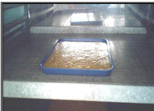
Fotografía 14: Bandejas dentro del Armario de Deshidratación
