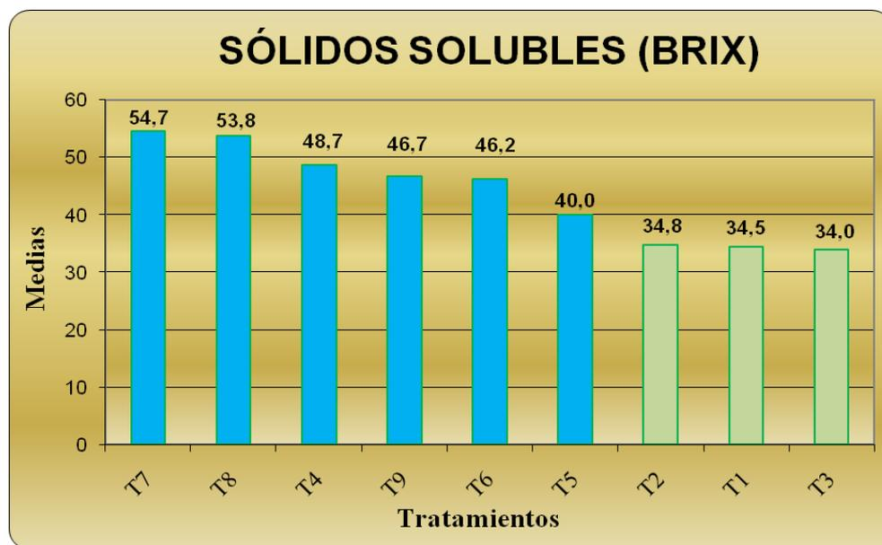
En el gráfico anterior, se aprecia que **T7** (temperatura de secado 55 °C y Caudal volumétrico del aire en el secador 0,0537m<sup>3</sup>/s), **T8** (temperatura de secado 55°C y caudal volumétrico del aire en el secador 0,0672m<sup>3</sup>/s), **T4** (temperatura de secado 45°C y caudal volumétrico del aire en el secador 0,0537m<sup>3</sup>/s); son los tratamientos que mayor sólidos solubles presentan en el producto terminado.
