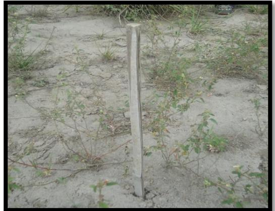
**Foto 8 Colocación de estacas para la medición de altura**
