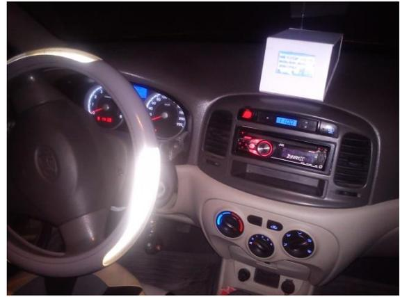
Fig.2 Taxímetro instalado en un vehículo Hyundai Accent 2010 con odómetro digital.
